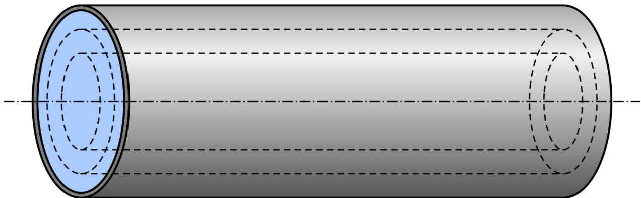
Obsérvese que el volumen de control es un cilindro hueco, dentro del fluido, pero que no incluye ni la pared ni el centro de la tubería. Este volumen de control es una “envoltura” porque envuelve parte del sistema analizado. Por esta razón, a este tipo de balance diferencial también se le conoce como “balance envolvente”.
