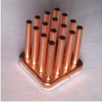
Considérese un dispositivo de enfriamiento que está conformado por 16 aletas cilíndricas de cobre (1.9 mm de diámetro, 10.4 mm de longitud). La temperatura de la base es 55 °C, la del aire circundante es 25 °C, y el coeficiente de transferencia de calor por convección es 950 W/m<sup>2</sup>·K. Determinar la eficiencia de las aletas, cuánto calor disipa cada una, y cuánto calor en total disipa el dispositivo. La conductividad térmica del cobre es 401 W/m·K.
